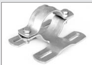
R 107 D Rohrschelle Stahl mit Doppelsteg (3,5 mm). Einschließlich verzinkten Schellenschrauben M8x25 und Muttern, geschlitz für Standardlochung M6
