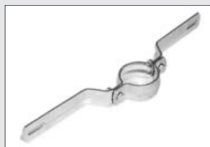
R 135 Rohrschelle Stahl (3,5 mm). Einschließlich verzinkten Schellenschrauben M8x25 und Muttern, geschlitz für Standardlochung M6
