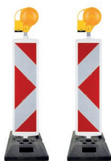
Sicherheits-Leitbakensystem TL-Leitbake, BAST-geprüft, mit Pfeilfolie rechts-/linksweisend in Reflektions- klasse RA2/B, TL-Fußplatten nach K1, Warnleuchte BakoLight LED
