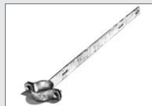
RE 135 VK Rohrschelle-Einarm Stahl (5,0 mm), vor Kopf geschweißt. Einschließlich verzinkten Schellenschrauben M8x25 und Muttern, geschlitz für Standardlochung M6
